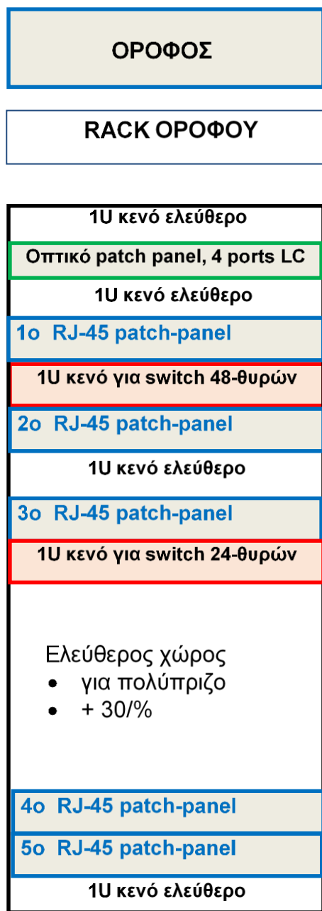
Εικόνα 6. Ενδεικτικό σκαρίφημα διάταξης περιεχομένου του οροφικού RACK
