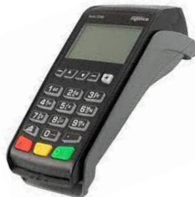
**Προσοχή, είναι απαραίτητο να διαθέτετε καλώδιο ethernet και να το έχετε συνδέσει στην αντίστοιχη θύρα του τερματικού (RJ45 σε RJ9), καθώς και να έχετε αλλάξει τον τρόπο λειτουργίας του τερματικού από Dial up σε Ethernet (Παράρτημα Β)**
