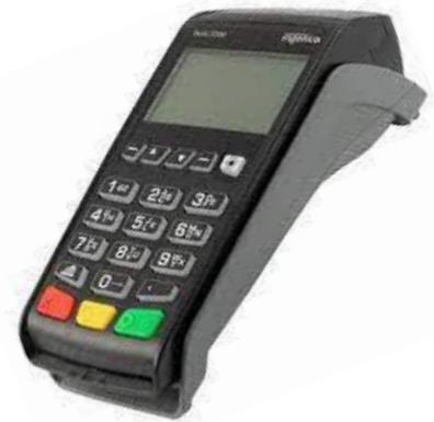
**Προσοχή, είναι απαραίτητο να διαθέτετε καλώδιο ethernet και να το έχετε συνδέσει στην αντίστοιχη θύρα του τερματικού (RJ45 σε RJ9), καθώς και να έχετε αλλάξει τον τρόπο λειτουργίας του τερματικού από Dial up σε Ethernet (Παράρτημα Β)**
